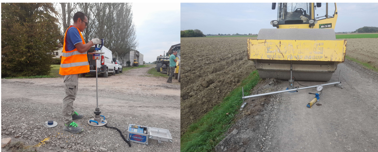
Esempio di prove di portanza dei sottofondi (piastra dinamica e piastra statica)
