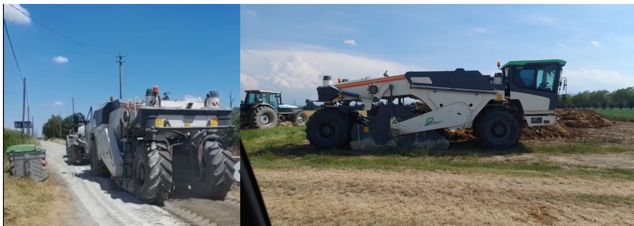
Mezzo utilizzato per la stabilizzazione in sito
