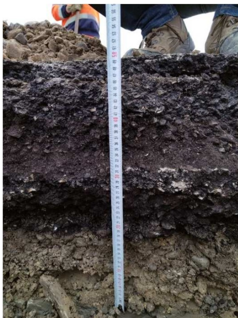
Tipico pozzetto ispettivo di una strada di campagna e rappresentazione grafica di carotaggi
