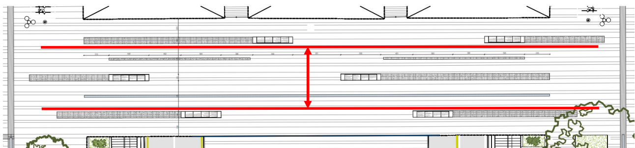
Figura 99: individuazione porzione carrabile del viadotto
