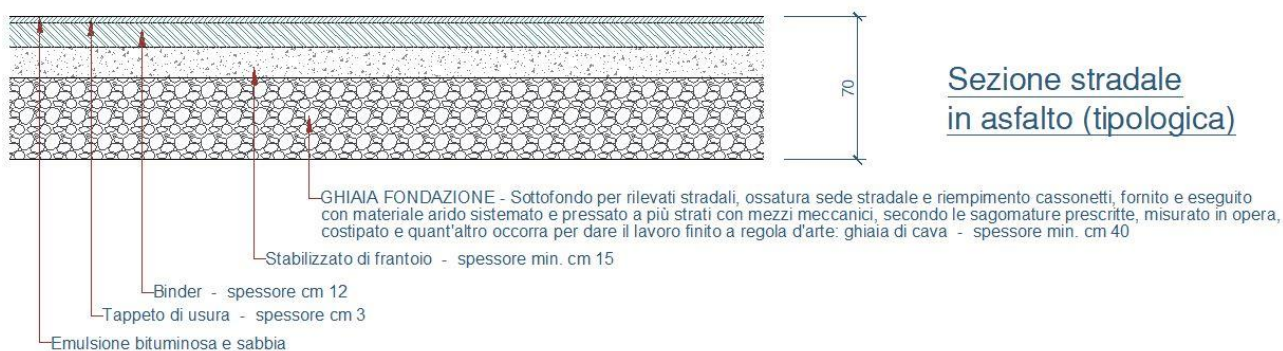
Figura 11 - Stratigrafia sezione stradale di progetto
