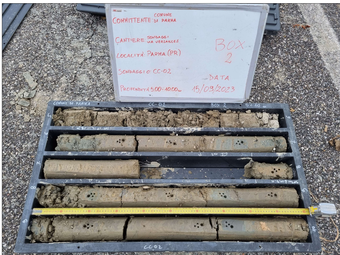
RAPPRESENTAZIONE FOTOGRAFICA - Sondaggi Via Versailles CASSETTE CATALOGATRICI 0.00-5.00 E 5.00-10.00 m
