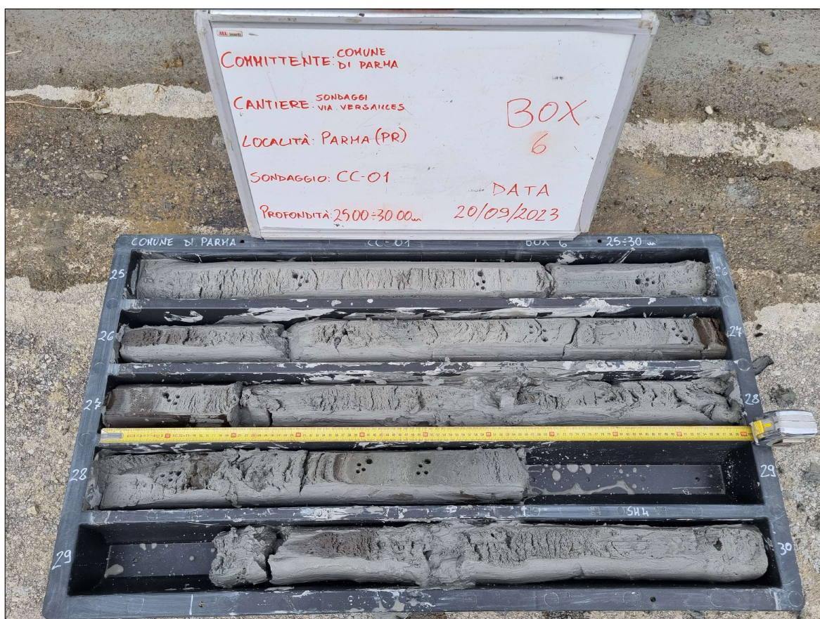
RAPPRESENTAZIONE FOTOGRAFICA - Via Versailles CASSETTE CATALOGATRICI 20.00-25.00 E 25.00-30.00 m
