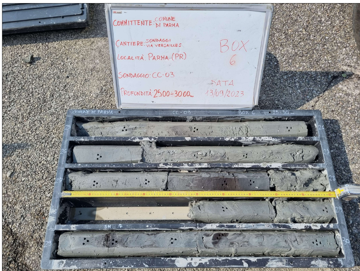
RAPPRESENTAZIONE FOTOGRAFICA - Sondaggi Via Versailles CASSETTE CATALOGATRICI 20.00-25.00 E 25.00-30.00 m
