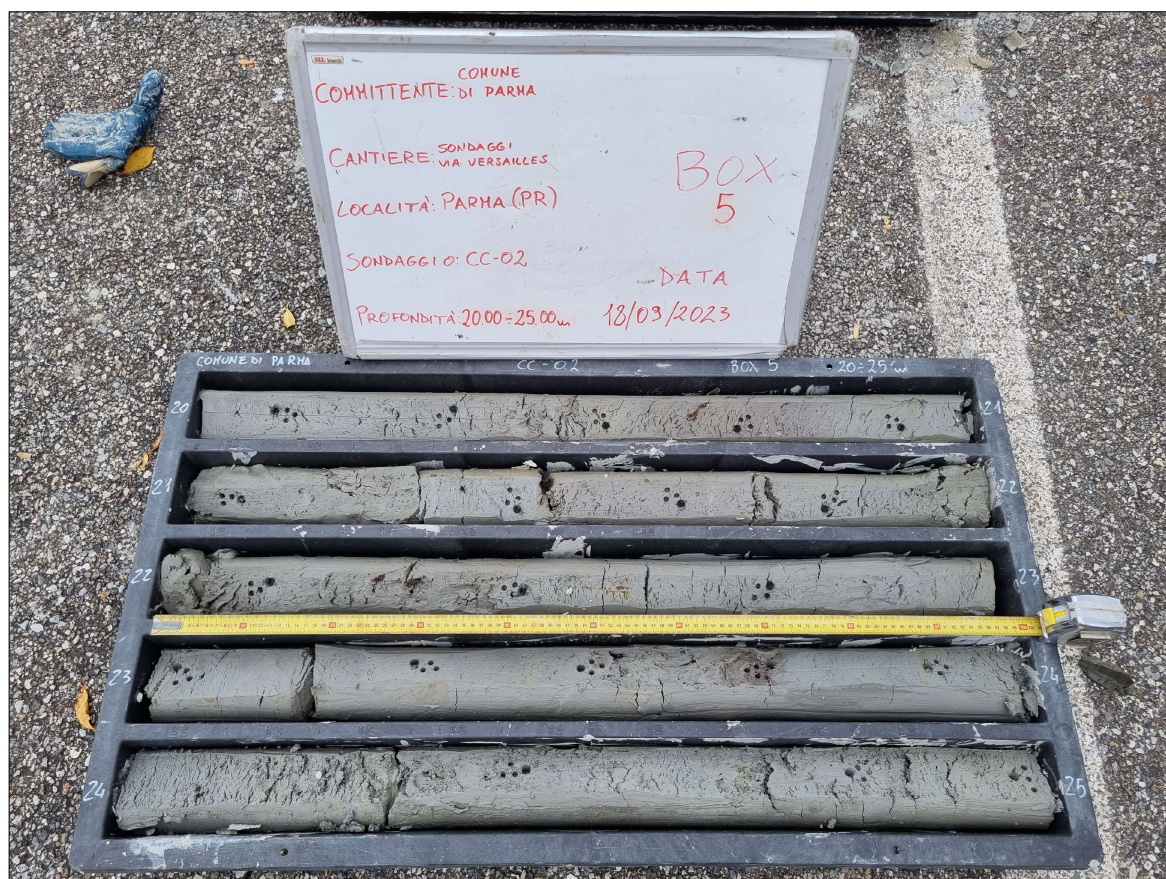
RAPPRESENTAZIONE FOTOGRAFICA - Sondaggi Via Versailles CASSETTE CATALOGATRICI 10.00-15.00 E 15.00-20.00 m
