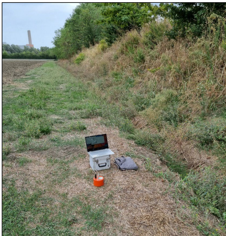
Figura 13 – Installazione strumentazione HVSR
