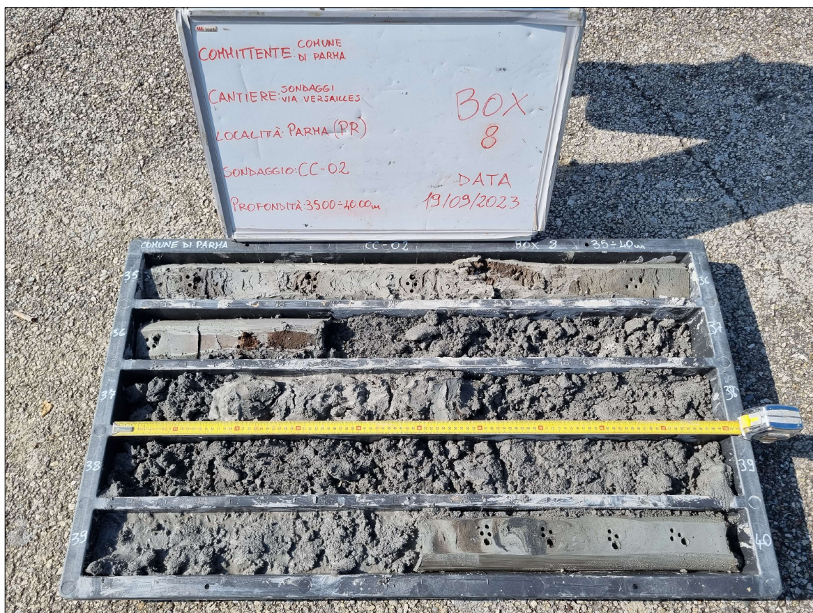
RAPPRESENTAZIONE FOTOGRAFICA - Sondaggi Via Versailles CASSETTE CATALOGATRICI 30.00-35.00 E 35.00-40.00 m
