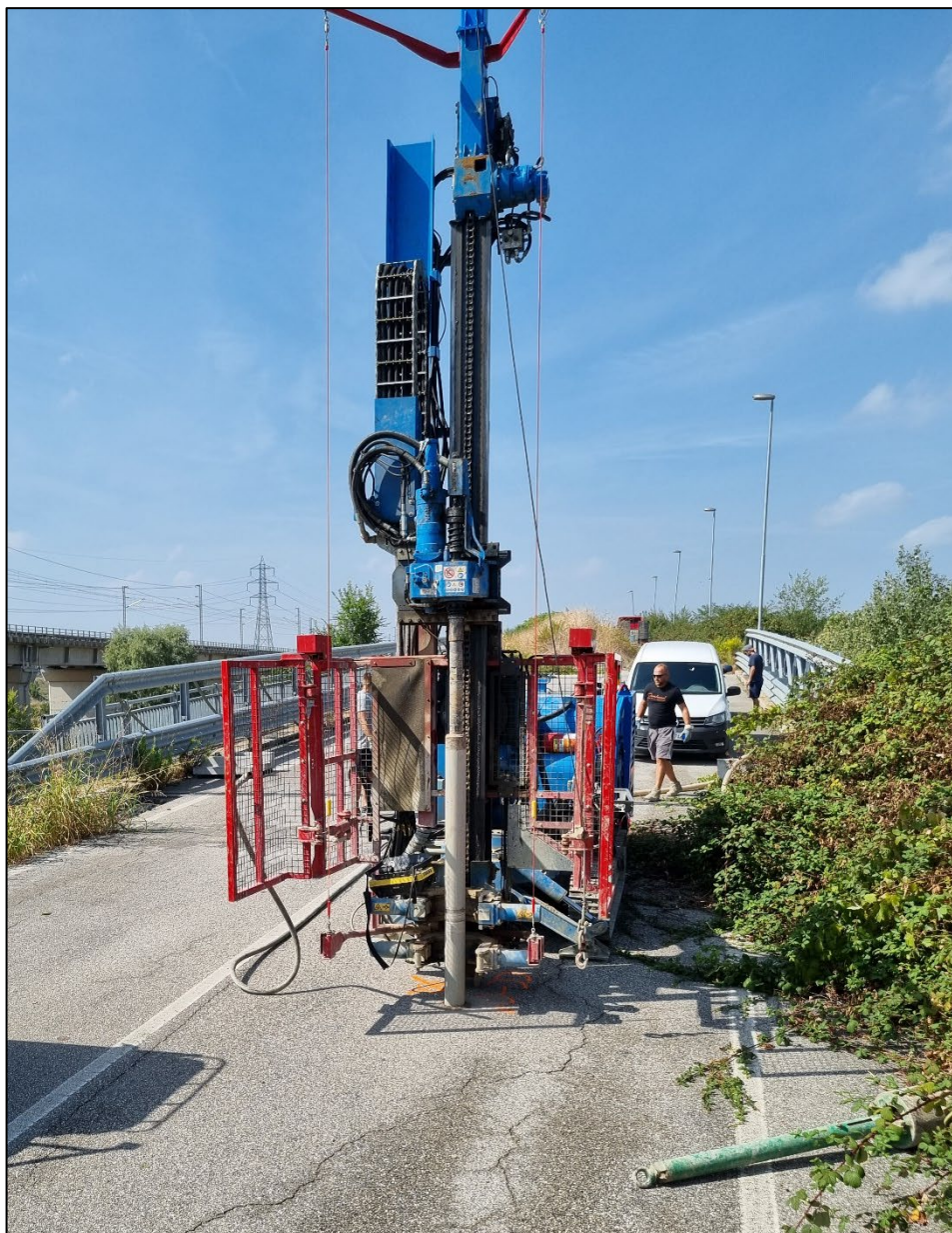
Figura 2 – Sonda perforatrice marca Soilmec, modello SM-6
