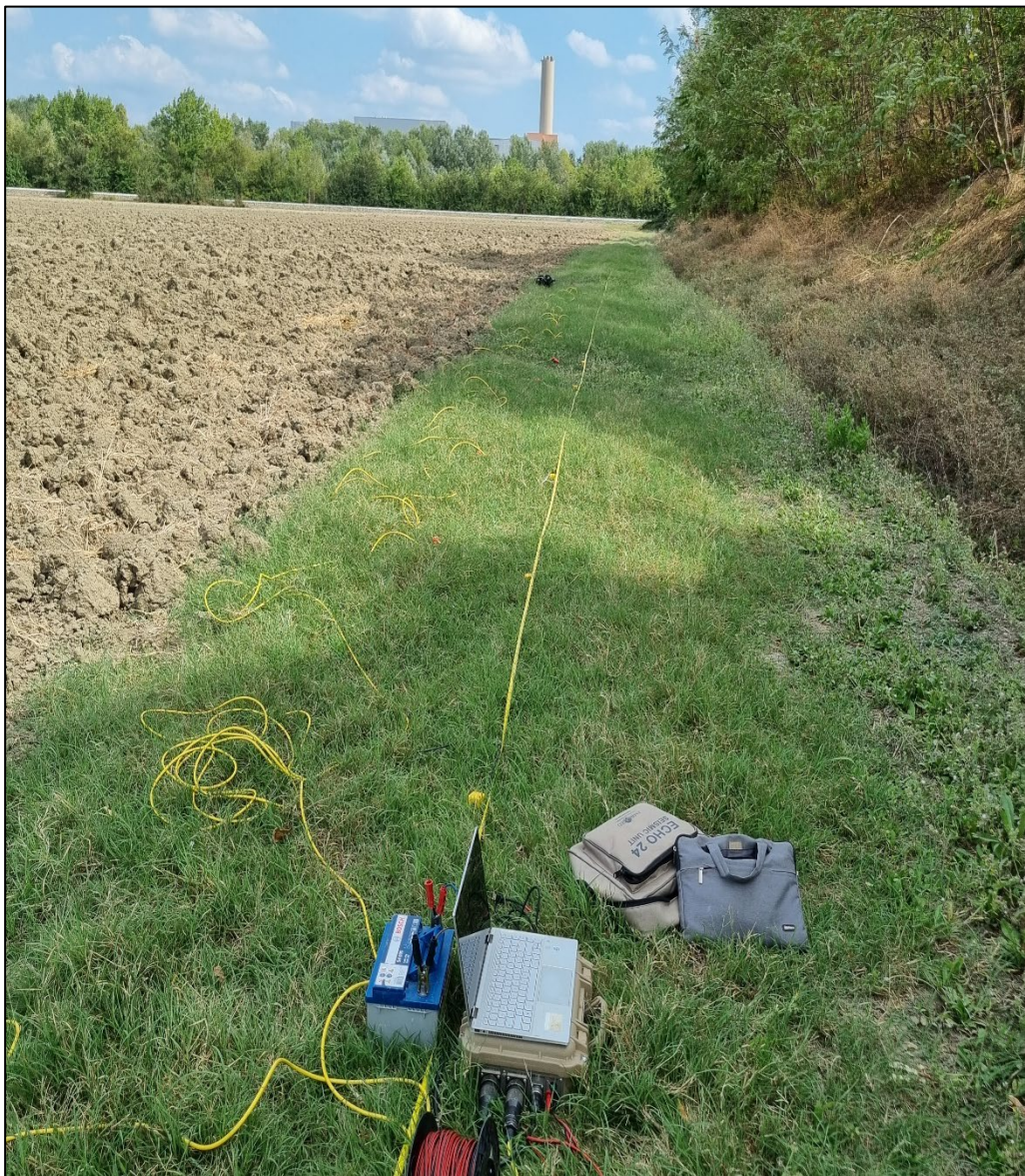
Figura 10 – Esempio della strumentazione utilizzata per l'indagine MASW
