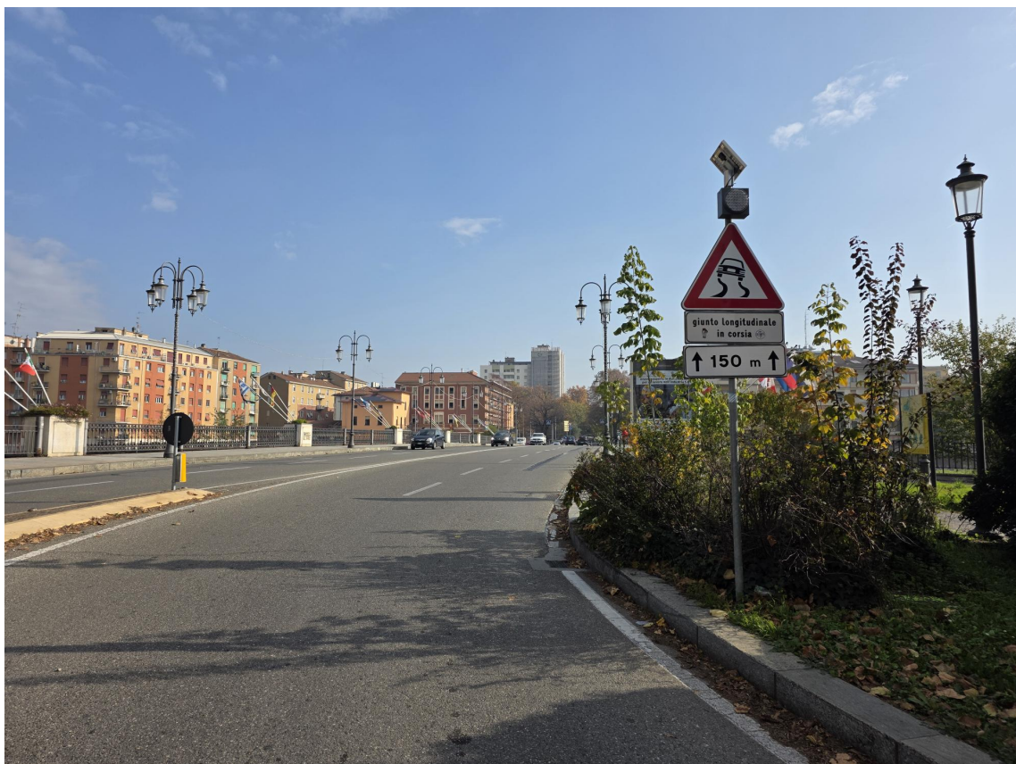
Fig. 5. Segnale lampeggiante che preavvisa del pericolo della presenza del giunto lato SUD
