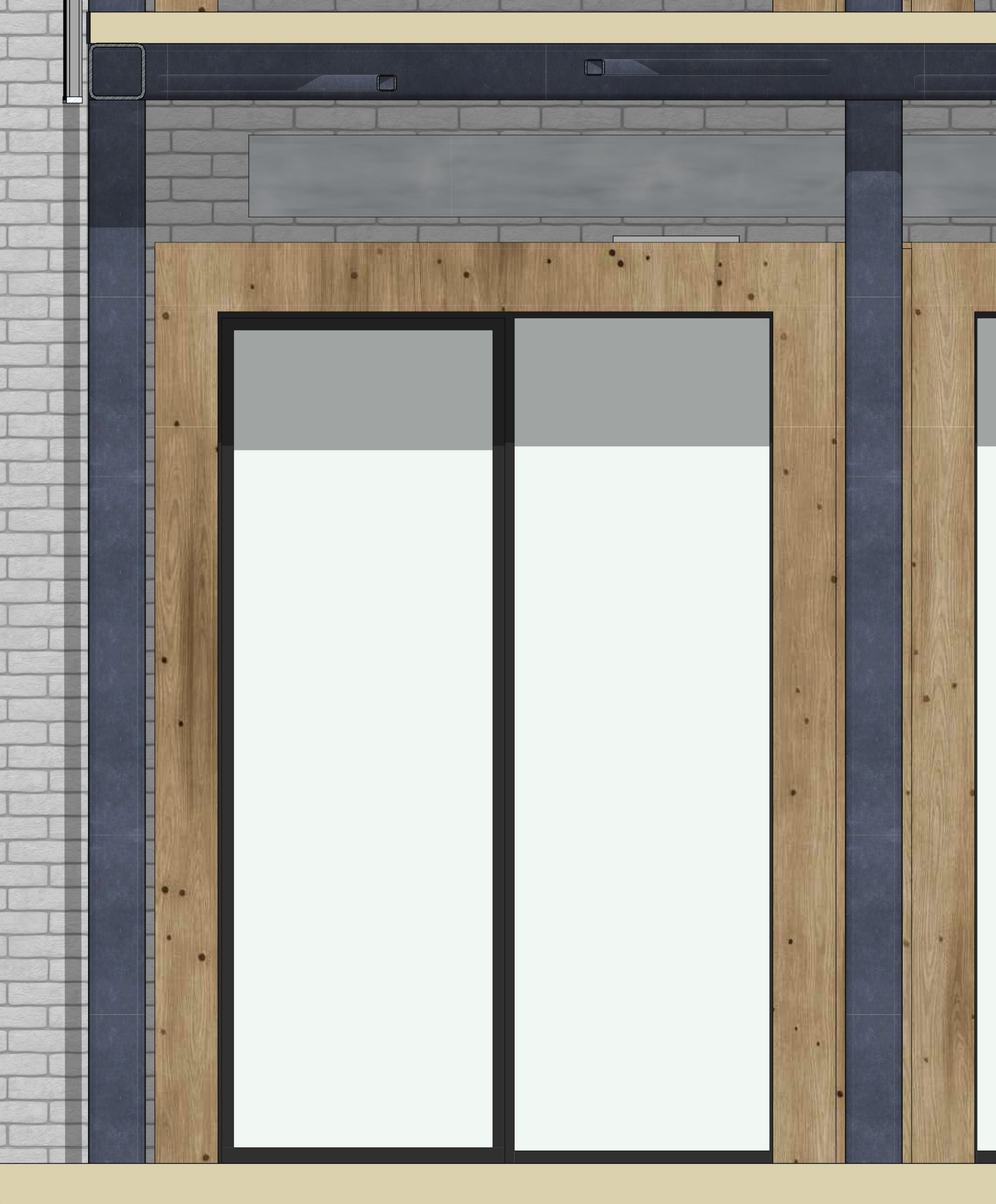
DETTAGLIO PORTALE IN LEGNO scala 1:10
