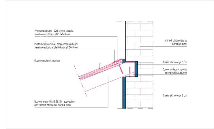
DETTAGLIO 5 . Appoggio travetti a mura di cinta . scala 1:10
