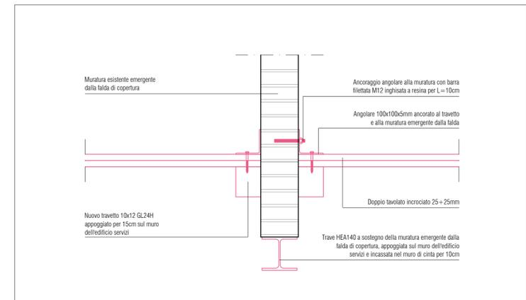
DETTAGLIO 7 . Ancoraggio piatte 50x5 mm e 100x8 mm . scala 1:10
