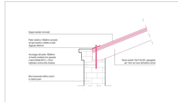
DETTAGLIO 6 . Ancoraggio piastra 100x8 mm e travetti a muratura . scala 1:10
