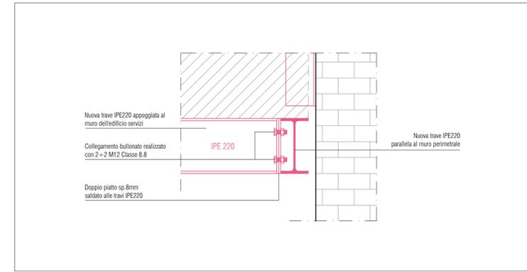
DETTAGLIO 3 . Collegamento bullonato travi IPE 200 . scala 1:10
