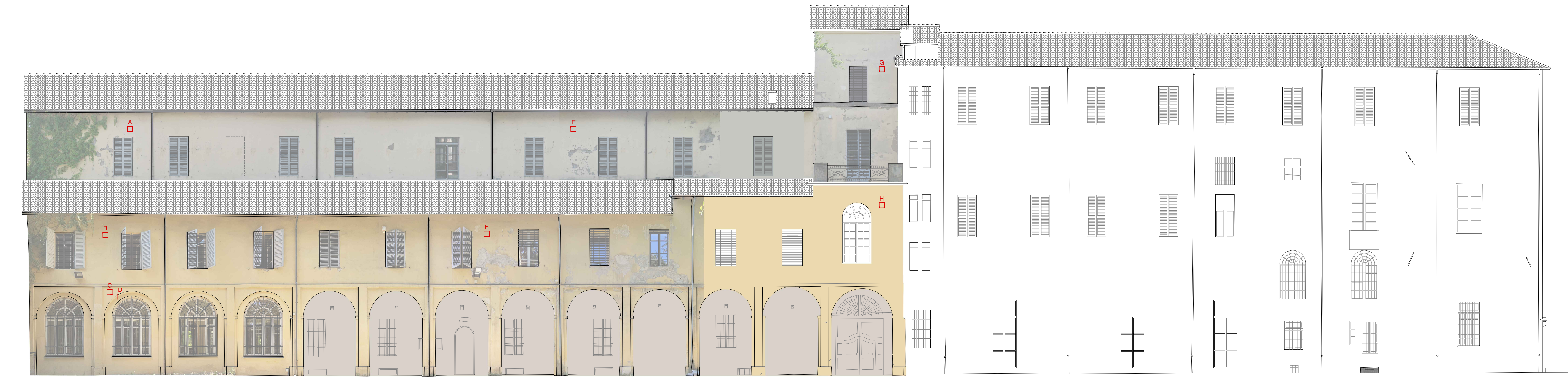
SAGGI STRATIGRAFICI - PROSPETTO NORD - scala 1:100
