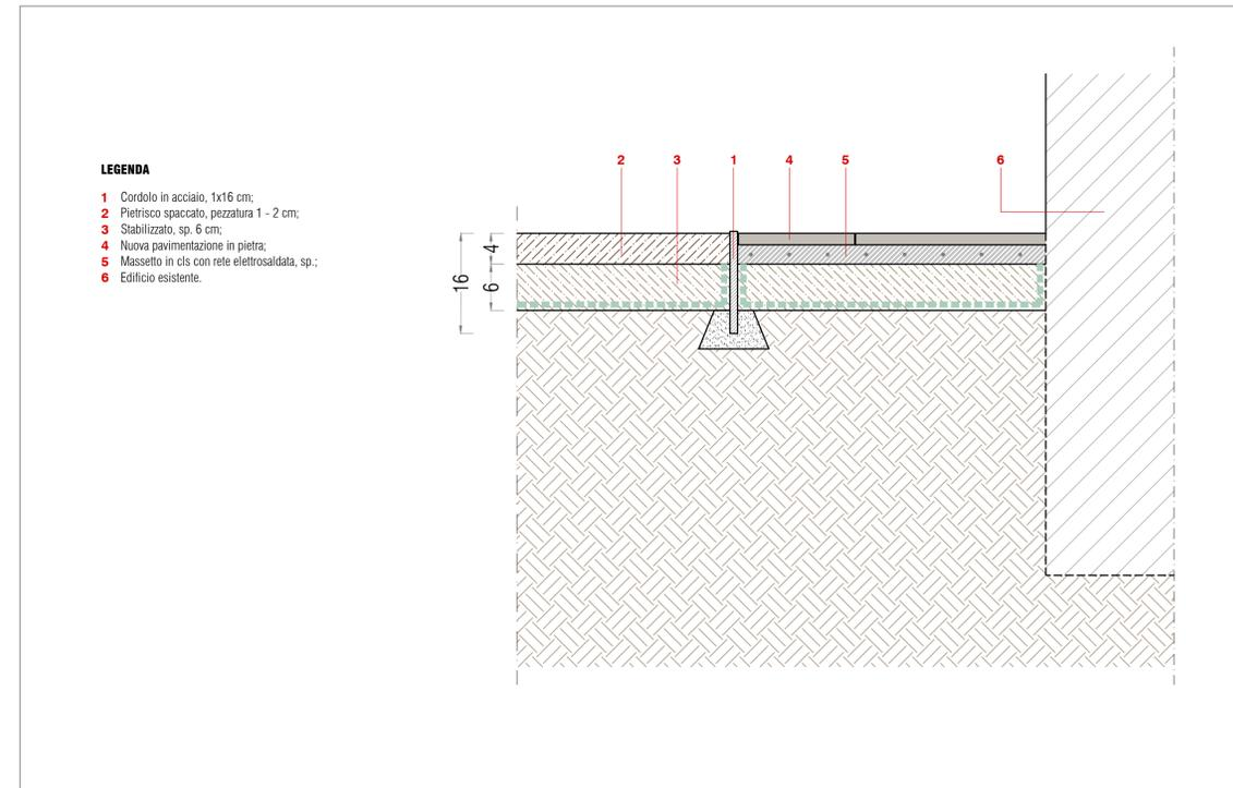
PROGETTO . DETTAGLIO C - INNESTO PAVIMENTAZIONE E MARCIAPIEDE BLOCCO SERVIZI IGIENICI . scala 1:10
