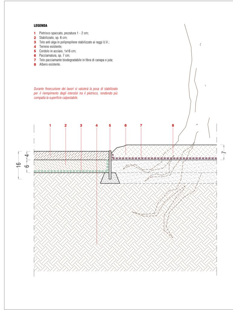
PROGETTO . DETTAGLIO A - AREE CON PAVIMENTAZIONE E PACCIAMATURA ALBERI . scala 1:10
