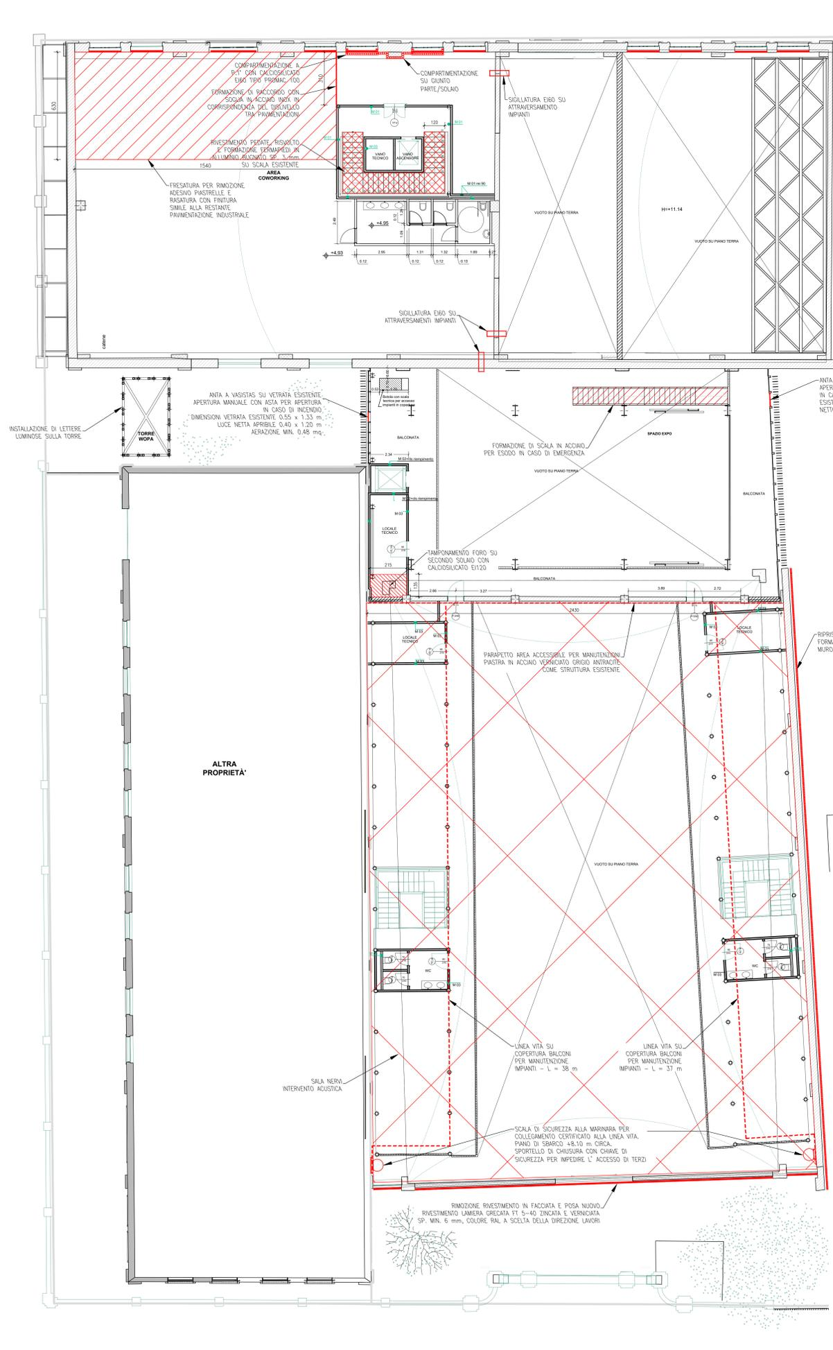
ANTA A VASISTAS SU SERRAMENTO ESISTENTE APERTURA MANUALE CON ASTA PER APERTURA IN CASO DI INCENDIO DIMENSIONI PANNELLO ESISTENTE 0,92 x 1,91 m NETTO APRIRE 0,70 x 1,70 m
