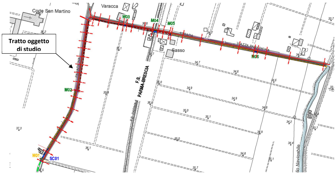
Figura 3: Sezioni trasversali lungo l'asta del canale
