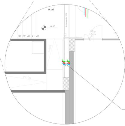
Rifacimento e spostamento a pavimento delle montanti impianto idrico sanitario per interferenza con la nuova rampa
