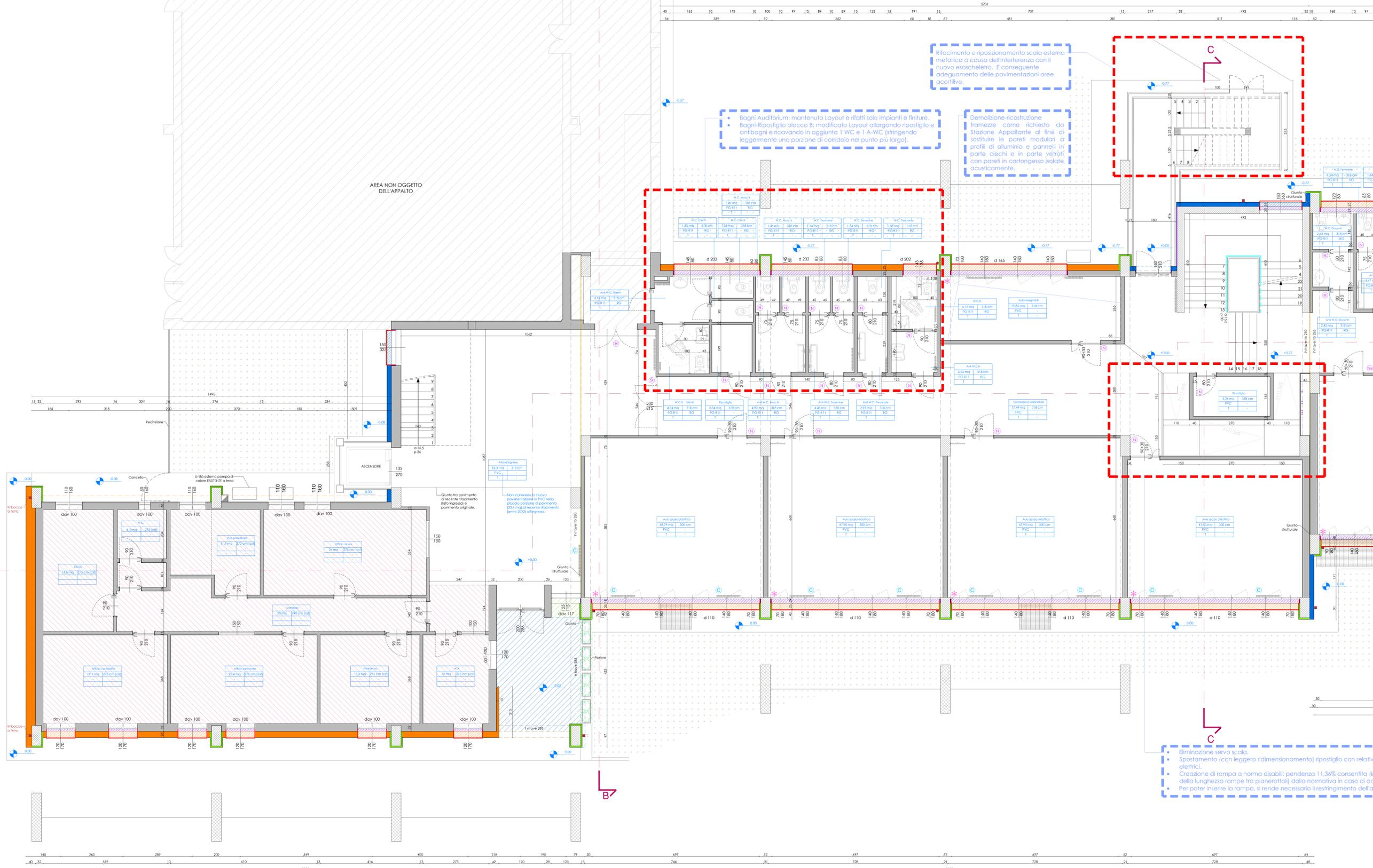
Rifacimento e riposizionamento scala esterna metallica a causa dell'interferenza con il nuovo essoscheletro. E conseguente adeguamento delle pavimentazioni aree acustive.
