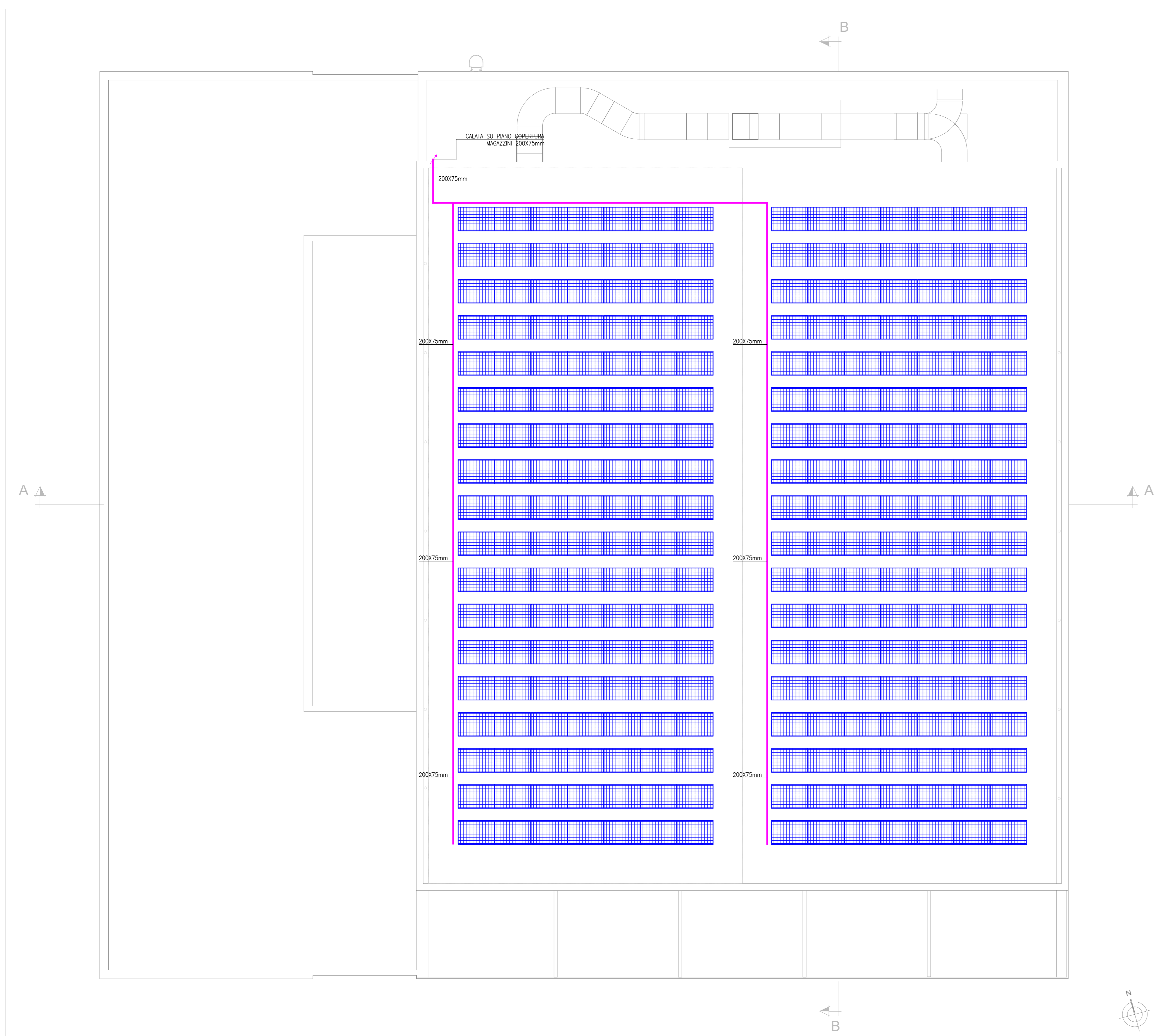
PIANTA PIANO COPERTURA – IMPIANTO FOTOVOLTAICO – SCALA 1:100
