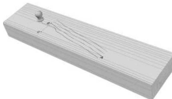
Misura dell’inclinazione fibratura tramite graffietto.
