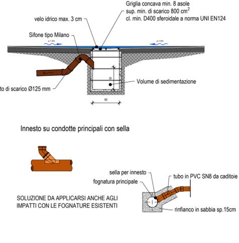
POZZETTO DI ISPEZIONE/CADITOIA IN LINEA CON SALTO DI FONDO PER CAMBIO DIAMETRO
