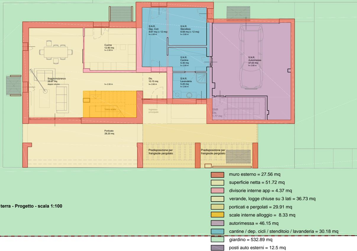
Pianta piano terra - Progetto - scala 1:100
