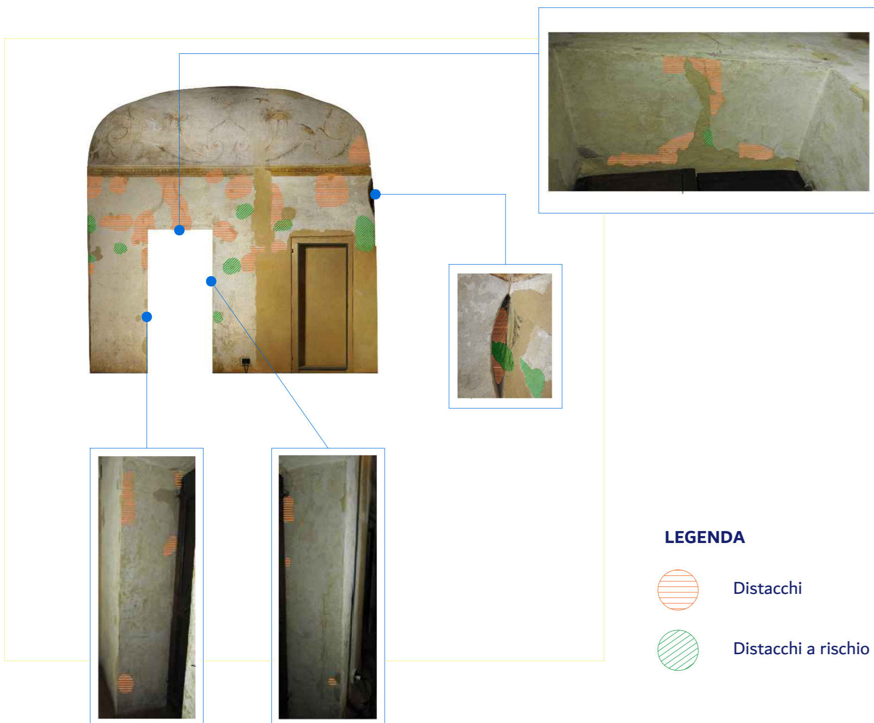
RILIEVO GEOMETRICO E QUADRO FESSURATIVO
