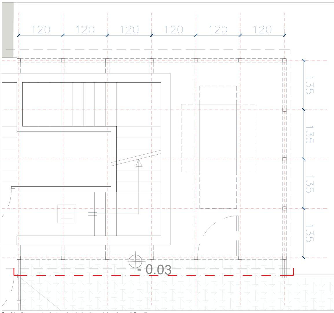
Pannellatura di tamponamento scala esterna e locale tecnico esterno \_ pianta maglia supporti già posati in opera
