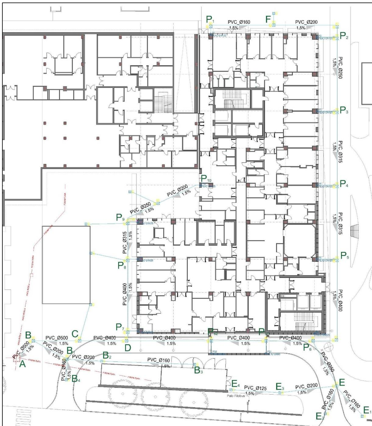
Figura 17 - Schema della rete di calcolo del reticolo fognario
