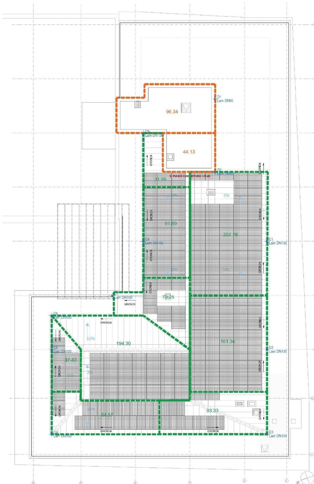
Figura 9 - Aree di influenza dei pluviali al piano del vano scala e copertura del vano tecnico
