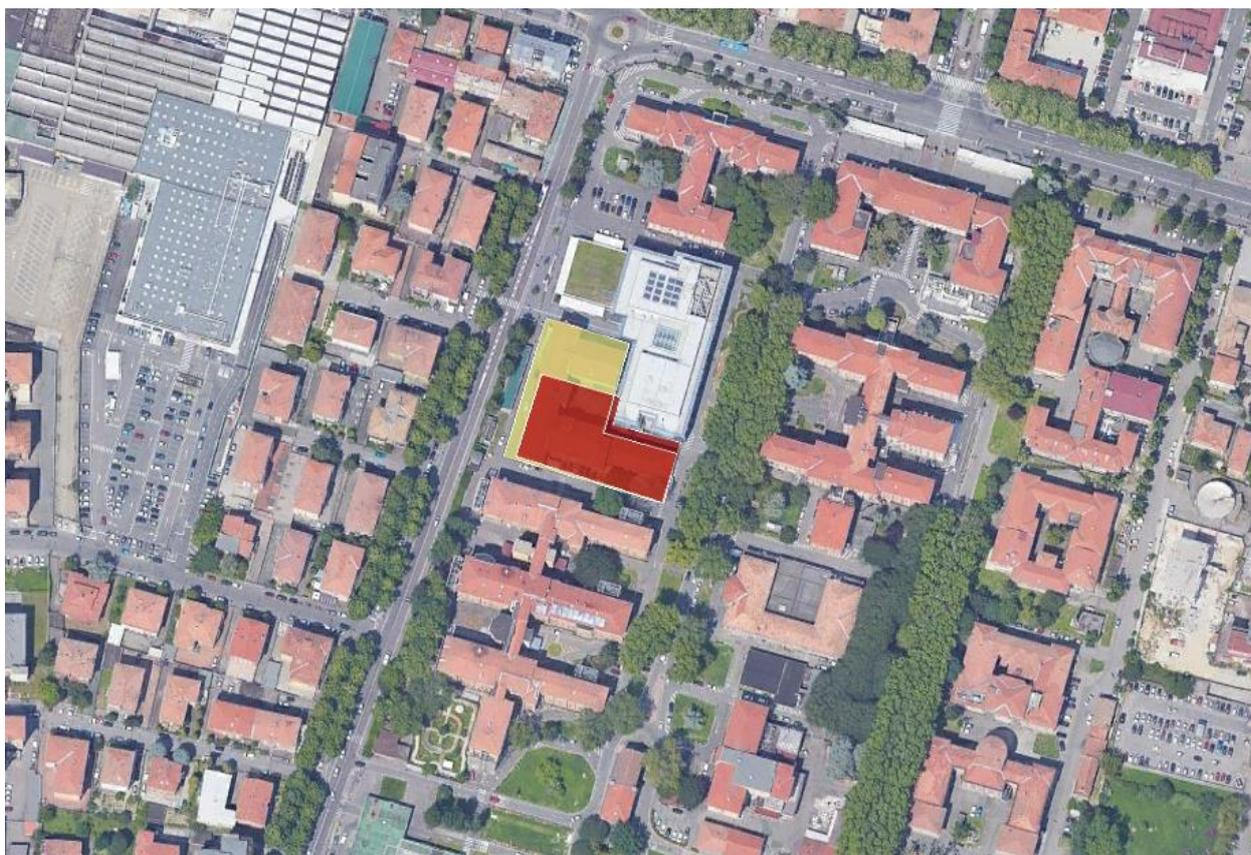
Figura 1 - Inquadramento dell'area di intervento. In giallo la demolizione ed in rosso la nuova costruzione
