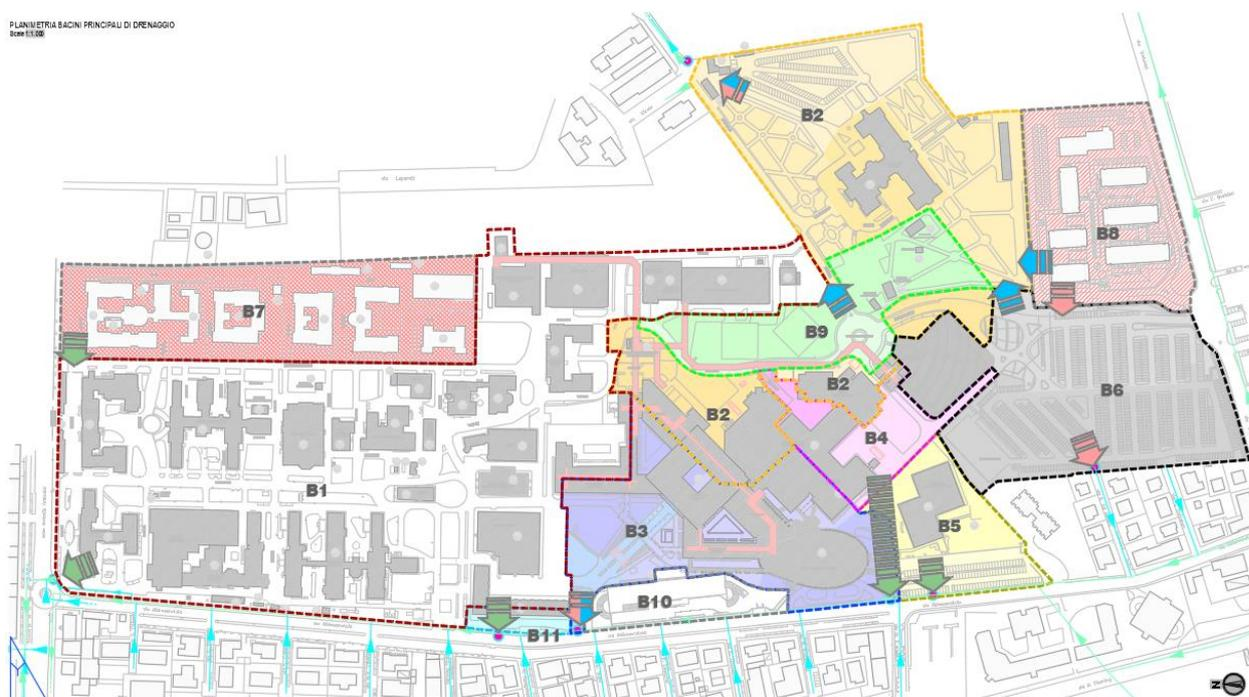
Figura 3 - Planimetria dei bacini dell'area ospedaliera (frecche verdi: scarichi acque di tipo misto; frecche azzurre: scarichi acque bianche; frecche rosse: scarichi acque nere)
