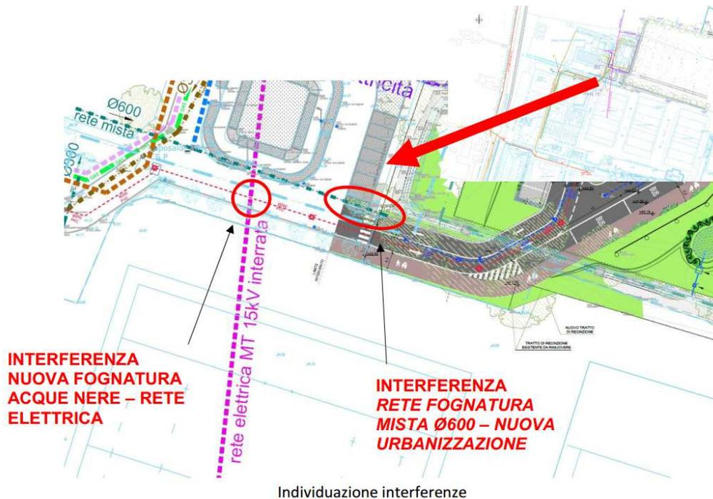
Si segnala inoltre la presenza di una rete fognaria bianca/mista con tubazione di  $\varnothing 600$  mm sul lato sud dell'intervento che recapita nel fosso esistente, interferente anche se pur marginalmente con la nuova viabilità in progetto di cui si prevede già in questa fase progettuale lo spostamento del tratto terminale.
