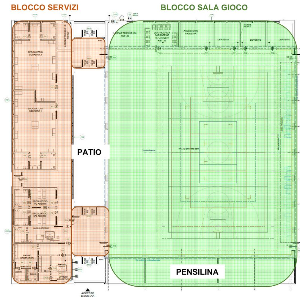
Il volume della sala gioco si sviluppa su una superficie di circa 982 mq e altezza interna libera pari a 7,70 m. A nord della sala gioco sono previsti: il deposito destinato alla ricarica delle carrozzine elettriche, un locale tecnico, una locale accessorio predisposto per essere utilizzabile come sala pesi, un locale deposito ed un ulteriore ambiente predisposto per un futuro utilizzo come sala riunioni.
