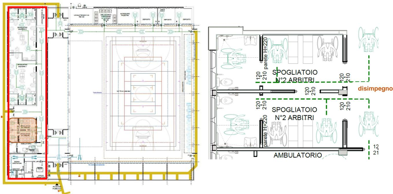
Ogni blocco, è raggiungibile dal corridoio comune tramite porte ad unica anta scorrevole di dimensioni 120x210cm con con maniglia a scomparsa e nottolino sul fianco per il richiamo. Ogni blocco spogliatoio si sviluppa su una superficie di circa 19 mq, è dotato rispettivamente di un locale spogliatoio oltre che da un servizio igienico, un lavabo ed una doccia. Anche in questo caso, gli spogliatoi sono attrezzati e dimensionati per ospitare utenti DA.
