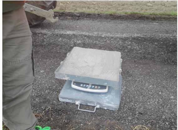
Strumentazione per la misurazione della portanza dei sottofondi e della quantità di cemento da utilizzabili in sito
