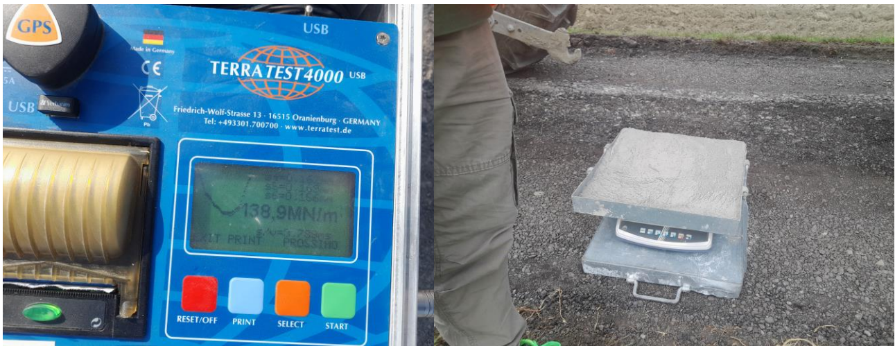
Strumentazione per la misurazione della portanza dei sottofondi e della quantità di cemento da utilizzabili in sito
