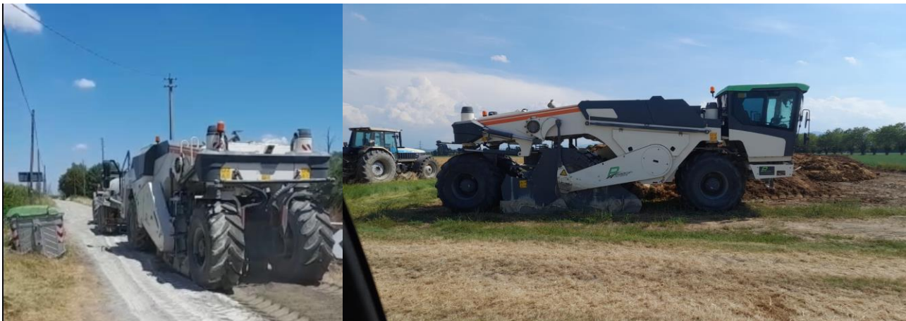
Mezzo utilizzato per la stabilizzazione in sito
