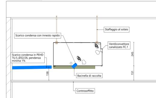
D.S.2 - Particolare scarico fancoil a cassetta FC.2 (scala 1:10)
